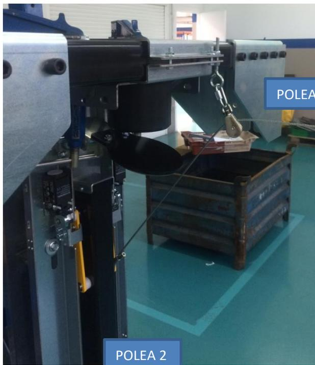
La polea 1 se coloca sobre el soporte del puffer.
